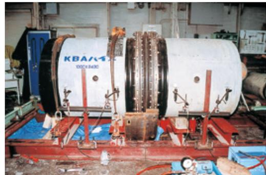
写真-7 せん断変位水密試験 (呼び径:1000)
