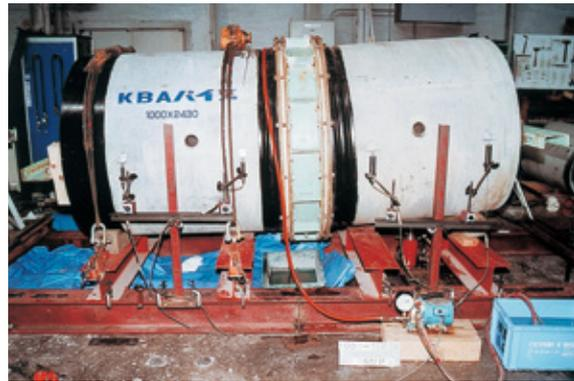
写真-6 曲げ水密試験 (呼び径:1000)
