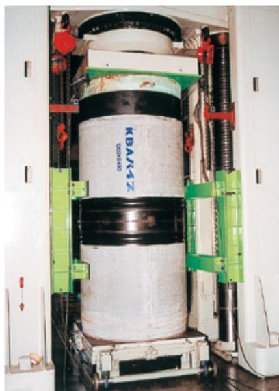
写真-3 軸力試験(呼び径:1000)
