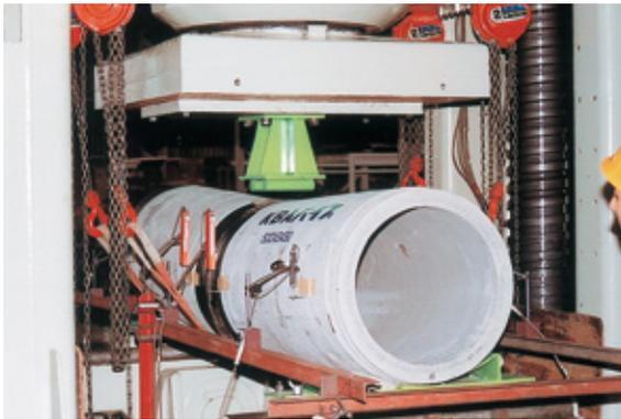
写真-5 曲げ試験 (呼び径:500)
