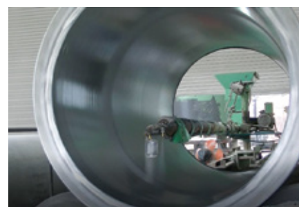
内面ライニング加工状況
